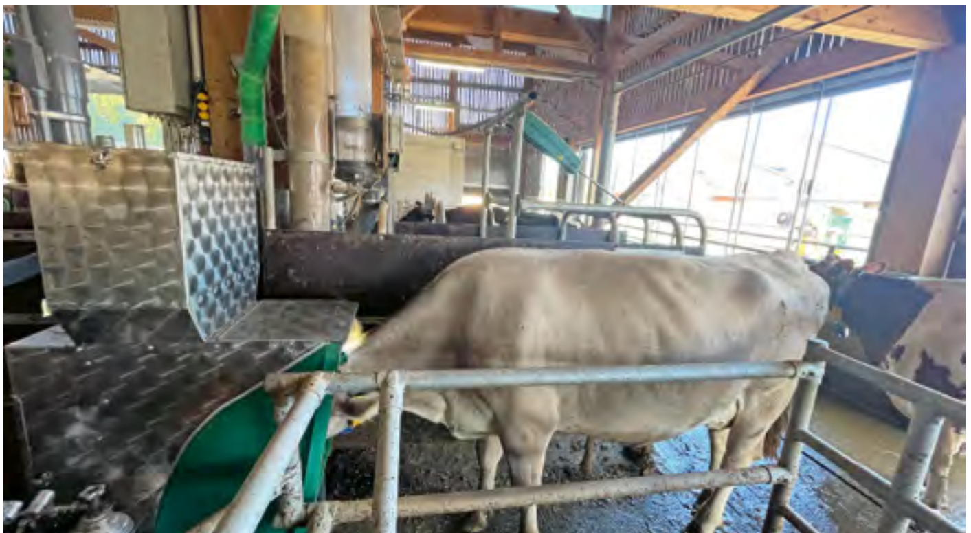
Mit dem GreenFeed werden Daten zum Methanausstoss eines einzelnen Tieres gemessen, welche für die Entwicklung einer Zuchtwertschätzung essenziell sind.
