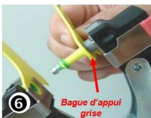
La pince fournie à la livraison est dotée d'une **bague d'appui grise** sur le poinçon en métal, qui vient étayer la partie mâle de la marque auriculaire lors de l'insertion. Si cette bague d'appui se détache à l'usage de la pince, reclipsez-la sur le poinçon.
