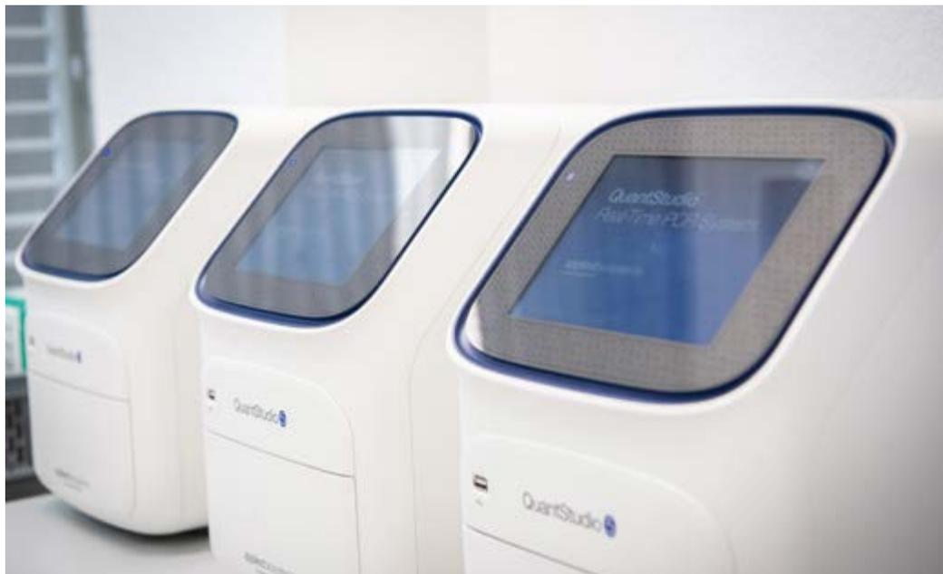
**Lors d'une analyse PCR, l'ADN des agents pathogènes est isolée à partir de l'échantillon de lait et est détectée par la multiplication ciblée de petits segments de gènes.**
