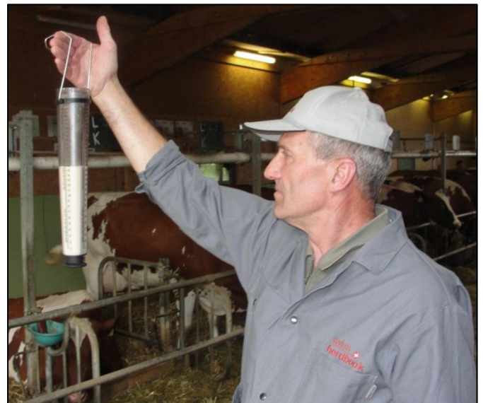
La quantité de lait est relevée à 100 g près sur le cylindre suspendu ou posé verticalement (attention : tare à 200 g) et aussitôt inscrite sur la fiche d'accompagnement.
